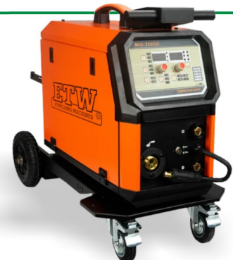
[MIG-250GD] Arco Pulsado y Doble Puls. Bobina 15kg. 1F/3F - 200A/250A(30%)
